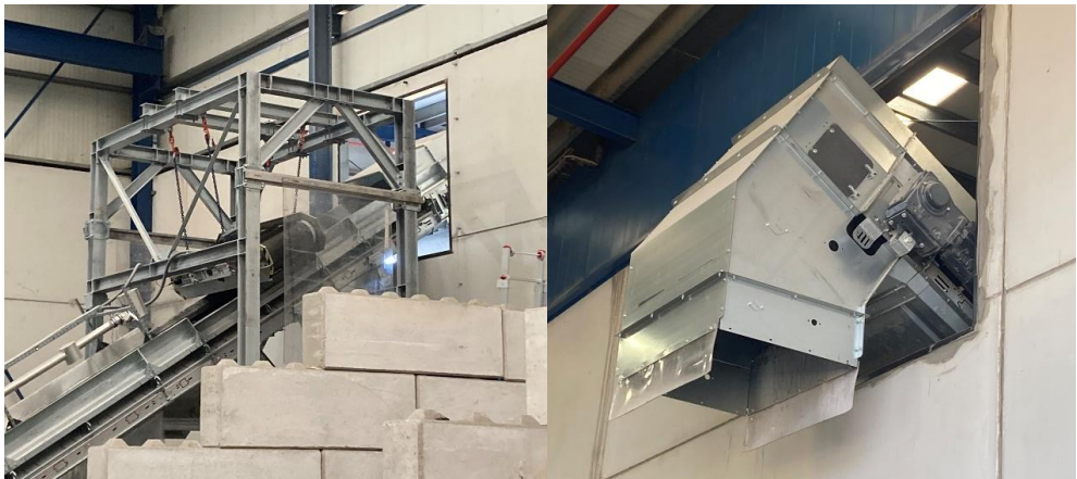
ILUSTRACIÓN 15: APERTURA RECTANGULAR PARA LA DESCARGA DEL MATERIAL TRITURADO.
